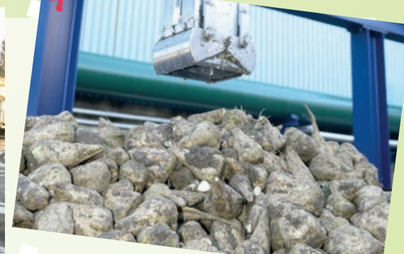
4 Mit einer Wasserkanone werden die Zuckerrüben aus den Wagen entladen.
